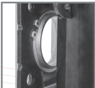
3. Seleccione la posición de la placa deseada, esto lo puede realizar sujetando el perno hacia afuera, gire la palca a la posición deseada y suelte el perno sobre el orificio de la posición requerida.
