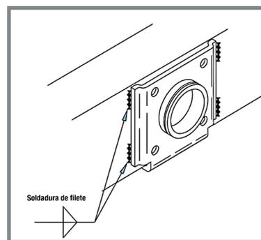
5. Monte nuevamente el gato en la placa ya soldada, coloque el perno y cierre correctamente el anillo de retención sobre la ranura, limpie y verifique la ranura en la placa antes de apretar el anillo de retención.
