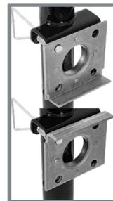
4. Coloque la placa contra la barra y soldé usando cuatro soldaduras de filete, cada una de al menos 2,54cm (1") largo.
