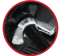
TORNILLOS DE AJUSTE TIPO MARIPOSA PARA DISTINTOS ANCHOS DE ROLLOS DE FLEJE
