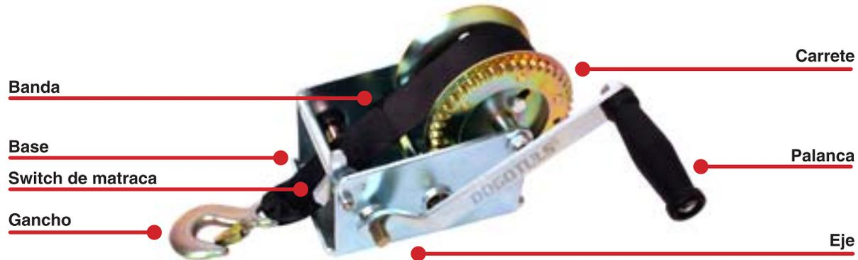
**1. Switch de matraca**-Existen tres posiciones para la matraca. La posición elevada es para jalar, la baja es para liberar y la del medio es para ambas jalar y liberar pero el restirador deberá de estar libre de carga. Cuando el restirador este cargado, sostenga la palanca fuerte para cambiar de posición.
