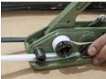
**2.** Comience a tensionar con el movimiento de la palanca. No sobre tensione el fleje para evitar daños en el empaque u objeto.
