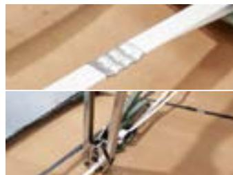
**4.** Corte del fleje. Al ejercer presión por completo en la palanca sobre la flejadora, el corte se hará automáticamente.
