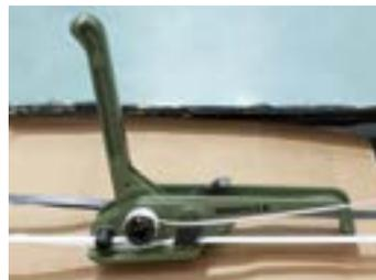
**3.** Proceda a colocar el sello sobre el fleje frente a la flejadora. Coloque la selladora sobre el sello y presione para fijar el sello al fleje. Retire la selladora. Se recomienda utilizar la selladora **NH2056** y sello **SM2005**.
