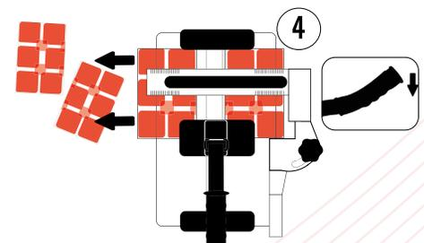
4-Una vez rayada la pieza, accione la palanca del separador hacia abajo y separe las piezas cortadas de azulejo
