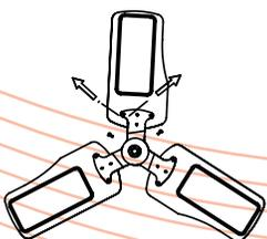
**10.-** Coloque las aspas en el eje del motor y fíjelas con las tuercas del paso 9. paso.
