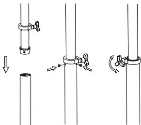
**6.-** Coloque el motor al poste superior y fíjelo.
