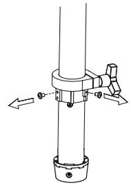
**5.-** Coloque el poste superior en el inferior y ajústelo a la altura deseada y asegúrelo con la tuerca triangular.
