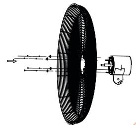
**9.-** Desenrosque las tuercas hexagonales de las aspas y guárdelas para el próximo paso.
