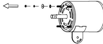
**8.-** Coloque la parrilla trasera en el motor y fíjela con los accesorios del paso 7.
