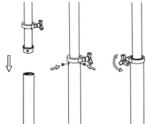
**6.-** Coloque el motor al poste superior y fíjelo.
