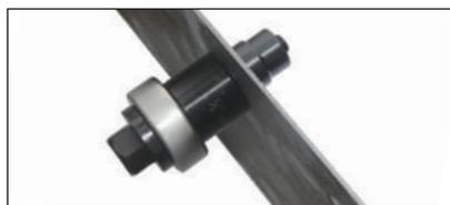
3. Coloque el punzón en la punta del tornillo y asegúrese que la parte con las cuchillas esté hacia la superficie a perforar.
