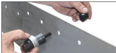
2. Coloque la matriz sobre el tornillo e inserte el mismo en la perforación que realizó con la broca anteriormente.
