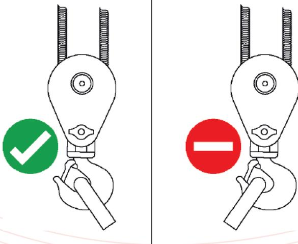
Las pastecas **DOGOTULS®** cuentan con una bisagra, la cual permite instalar la línea abriendo la pasteca en vez de pasar la línea completa a través de ella, esto elimina el uso de protectores de cable y permite diversos ángulos de entrada y salida de líneas para cambiar la dirección de la carga.
