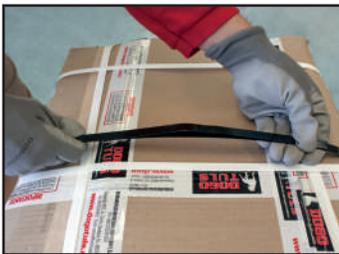
2. Presione el mango de la flejadora hacia abajo para levantar el rodillo, sin soltarlo coloque el fleje debajo del rodillo y suelte el mango. Ahora el fleje está asegurado y listo para tensionarlo.
