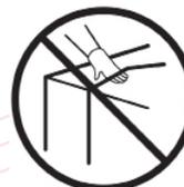
• No se coloque en línea con el fleje mientras lo tensiona, ya que éste pudiese reventarse y causar daños.
