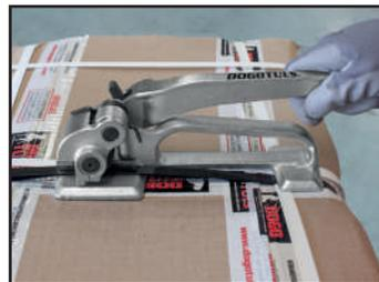
3. Detenga la flejadora con una mano y con la otra empuje el mango hacia adelante hasta que el fleje esté lo suficientemente tensionado. No sobre tensione el fleje para evitar daños en el empaque u objeto.
