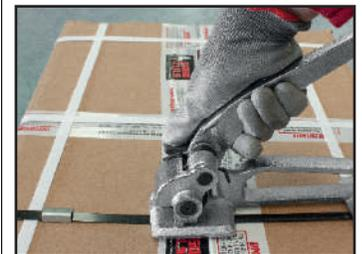
5. Coloque la selladora sobre el sello y presione para fijar el sello al fleje. Retire la selladora. (Se recomienda utilizar la selladora NH2045).
