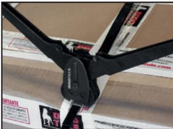
6. Vuelva a presionar el mango hacia abajo para levantar el rodillo y liberar el fleje. Ahora puede cortar el exceso de fleje. (Se recomienda utilizar cortadora de fleje NH2046)
