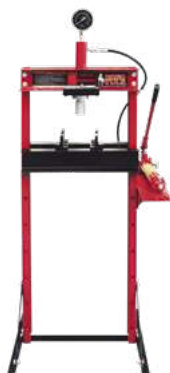
MANÓMETRO PARA MEDIR LA PRESIÓN APLICADA
